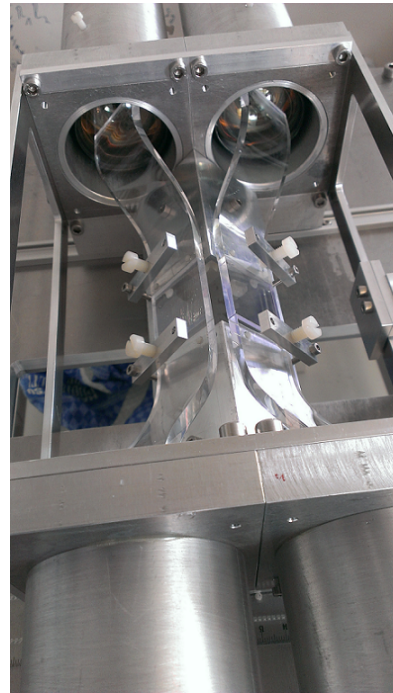
(b) Foto des zu verschiebenden Teils mit eingebauten Szintillatoren, Lichtleitern und Photomultipliern.
